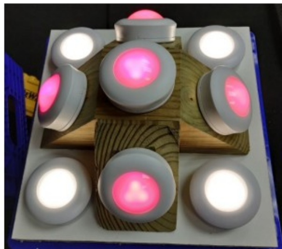
13. Ábra: Érintés precizitását tesztelő
